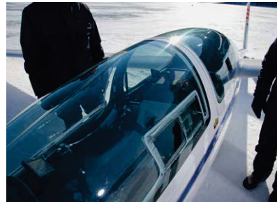
Øverst: Marcus Larsson gør klar i Landskronas DG1000. Nederst: Mange fly er udstyret med isoleret canopy for at modvirke, at hooden iser til indfra.
